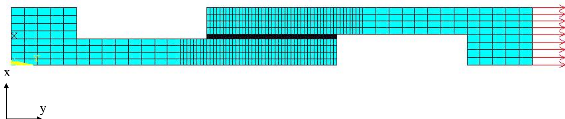
Figure 138. Chargement mécanique appliqué sur l'assemblage à simple recouvrement.
