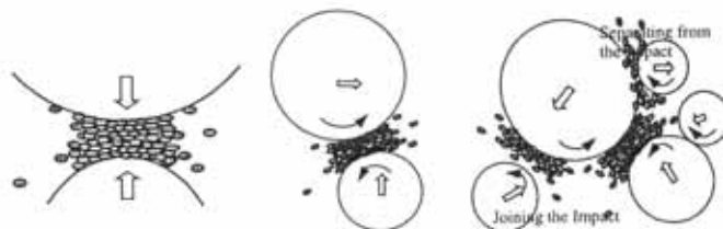
Figure 1.9: Diagramme schématisant des différents types d'impact possibles pendant le broyage (Zhang, 2004). De gauche à droite : impact frontal, impact oblique, impact multi-bille.
