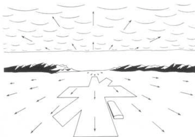
FIG. 2.8 – Représentation schématique du flux optique d'un avion ou d'un oiseau volant droit
