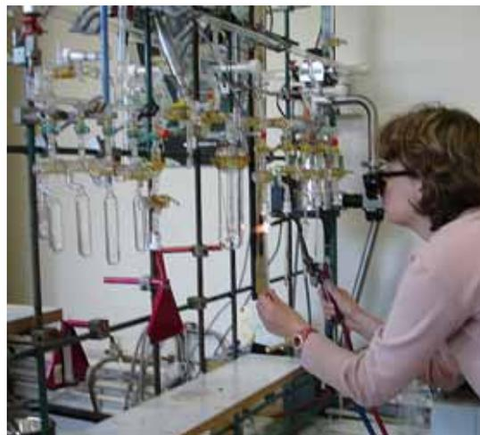
Figure 20 : Le scellage des tubes à essais à la flamme
