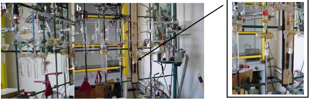
Figure 78 : Le banc de purification du CO<sub>2</sub> (a : les ampoule de récupération. b : le banc. c : les porte-échantillons)
