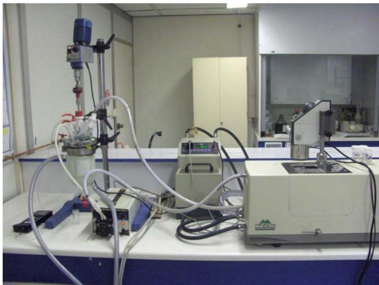
**Figure 4-2 :** Photographie du dispositif expérimental d'agrégation de la silice en cuve agitée avec circulation du milieu vers la cuve en ligne de l'Ultrasizer.
