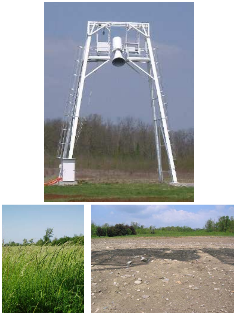
FIG. 3.8 – Radiomètre LEWIS et détail des surfaces observées.
