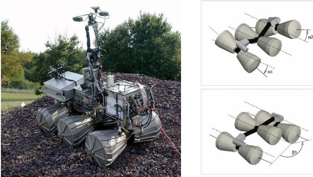
FIG. 3.2 – Le robot Lama et son châssis articulé
