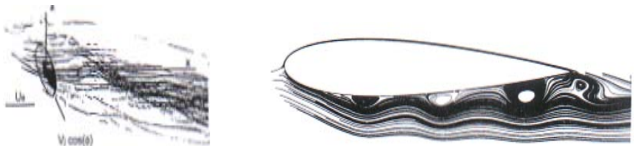
Figure 15: Création de structures macroscopiques par Vortex-Générateurs (à gauche) [102] et fente pulsée (à droite) [4]
