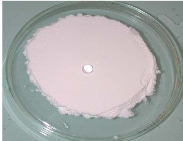
Figure II-13 Image d'une goutte d'eau posée sur les particules de cellulose microcristalline hydrophobe
