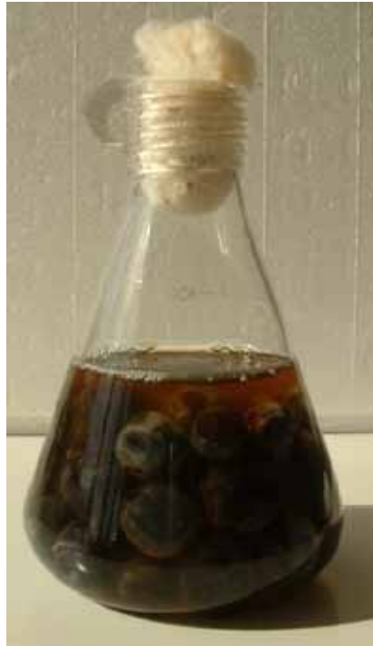
Figure 23: Exemple de baies directement incubées dans un erlenmeyer contenant du milieu d'enrichissement, ici le milieu EBB pour la détection de B. bruxellensis .
