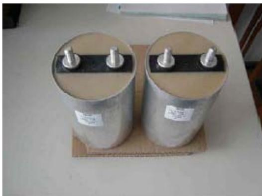
Figure A-11 Condensateurs du bus continu TPC FFL16L0397K
