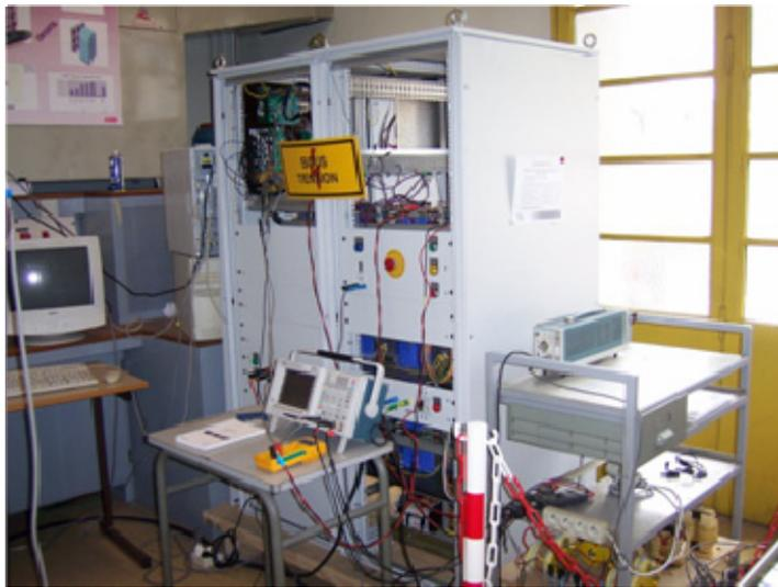
Figure A-1 Banc d'essais SMC 7 niveaux triphasé
