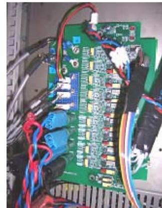
Figure A-16 Carte de prétraitement des signaux mesurés
