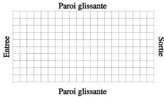
FIG. 5.19: Maillage et conditions aux limites utilisés pour la propagation d'un profil de vitesse.
