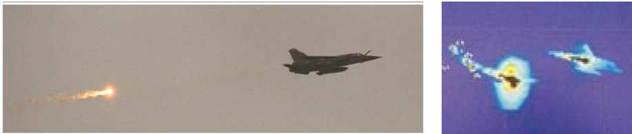
Fig. 1.1 : Prises de vue d'un avion larguant un leurre IR. Photographie prise dans le domaine du spectre du rayonnement visible (à gauche) et infrarouge (à droite).
