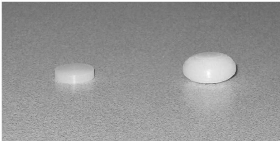
FIG. 2.1 – Exemples des corps utilisés : cylindres et ellipsoïdes aplatis
