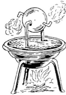
FIG. 1.12 - L'aeolipile construit par Hero d'Alexandrie.
