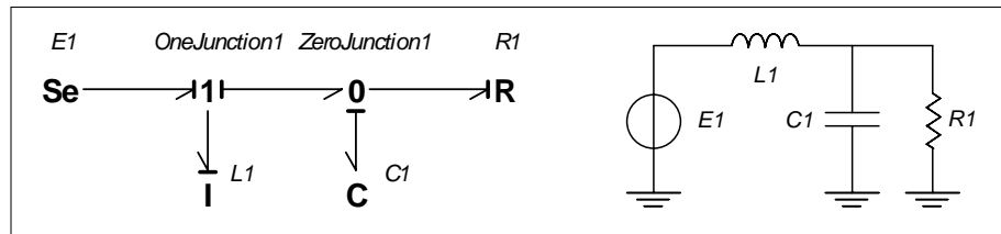
Figure B.3 : Exemple de schéma Bond Graph représentant un circuit électrique.
