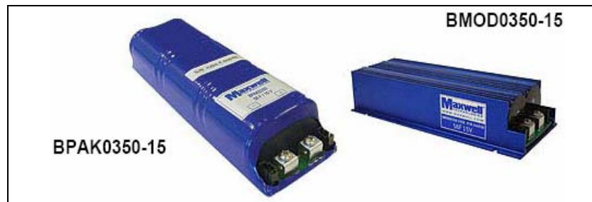
Figure III.8 : Modules 58 F / 15 V associant 6 supercondensateurs 350 F / 2,5 V [Max].
