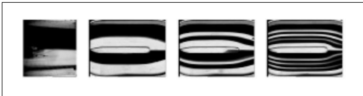
Figure I.17 : Visualisation par méthode photométrique du mélange de deux liquides non miscibles par de la rhodamine liquide [Schonfeld et al., 2004].
