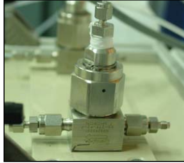
Figure II.2.8 : Photographie de la structure du filtre commercialisé par Swagelok (7 \mu\text{m} ).
