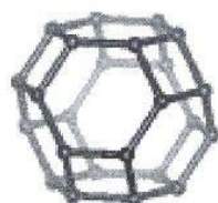
Figure I.29 Représentation schématique de la cage élémentaire de cristal de tamis moléculaire type A en forme de cube octaédrique [159].
