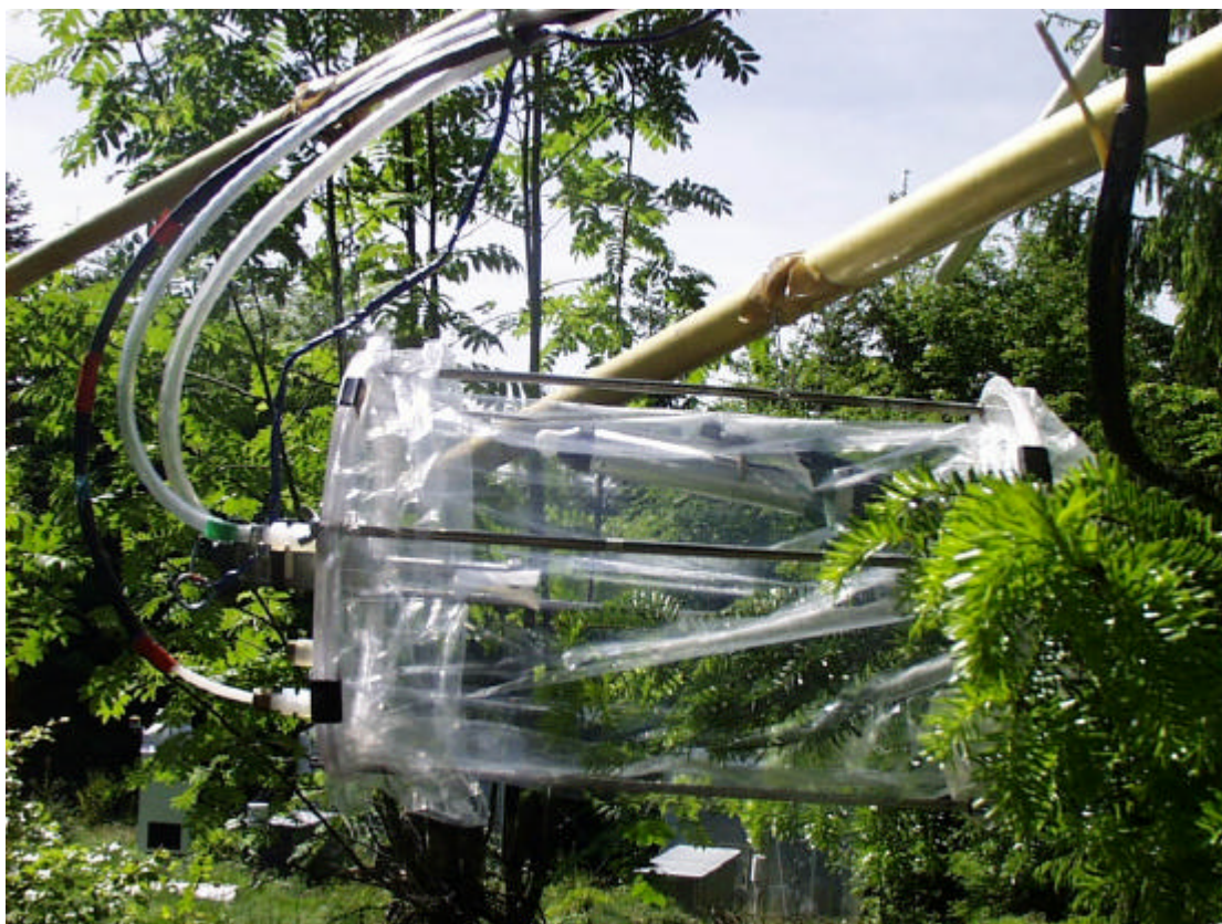
Figure I-9 : Exemple de cuvette instrumentée de type semi-rigide (campagne INTERREG III)
