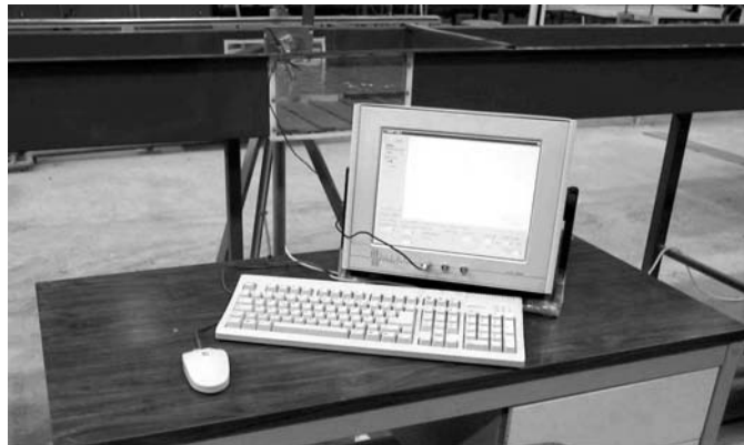
Figure 2.6 : Le vélocimètre Dop2000 (modèle 2032) et la sonde TR1028A (Sonde immergée dans l'écoulement)
