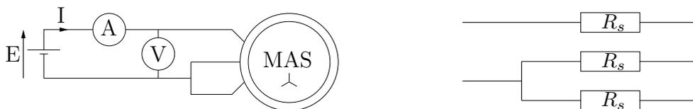
FIG. 4.7 – Câblage mis en œuvre pour la mesure de la résistance statorique  $R_s$
