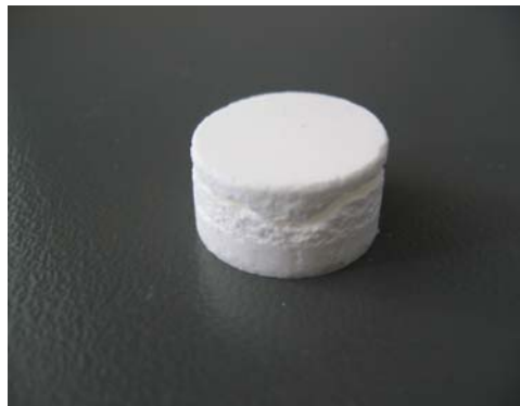
Figure I.3. Clivage d'un compact de lactose après éjection.
