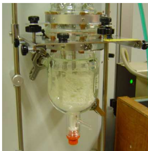
(a) Photographie de l'ensemble des agglomérats formés lors du refroidissement ( N=50 \text{ tr}\cdot\text{min}^{-1} )
