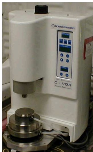
FIG. V.8: Photographie du rhéomètre Bohlin CVOR 200
