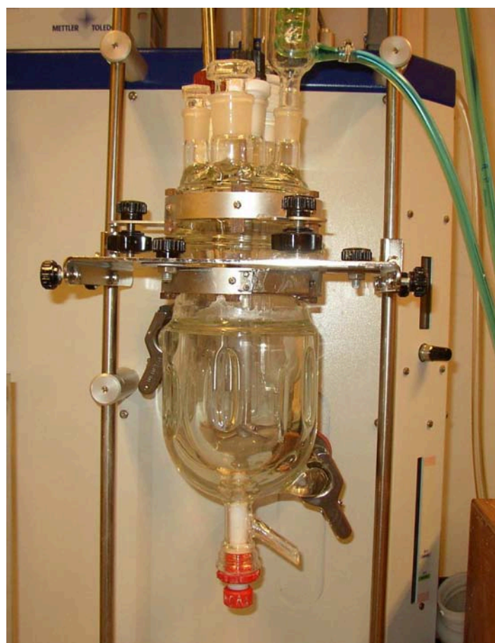
FIG. IV.2: Photographie du cristalliseur de 750 mL
