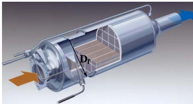
Figure II.2. : Détail du dispositif d'alimentation du FAP (image Opel)
