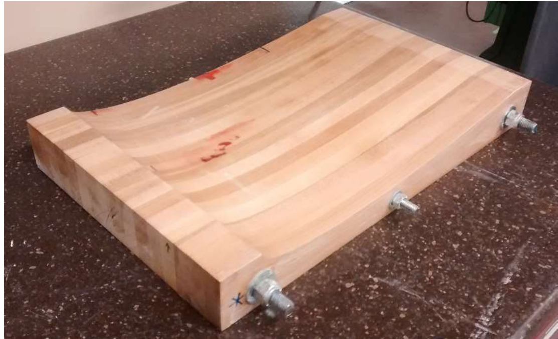
Figure 17: Moule de la pale basée sur un profil NACA 0012.
