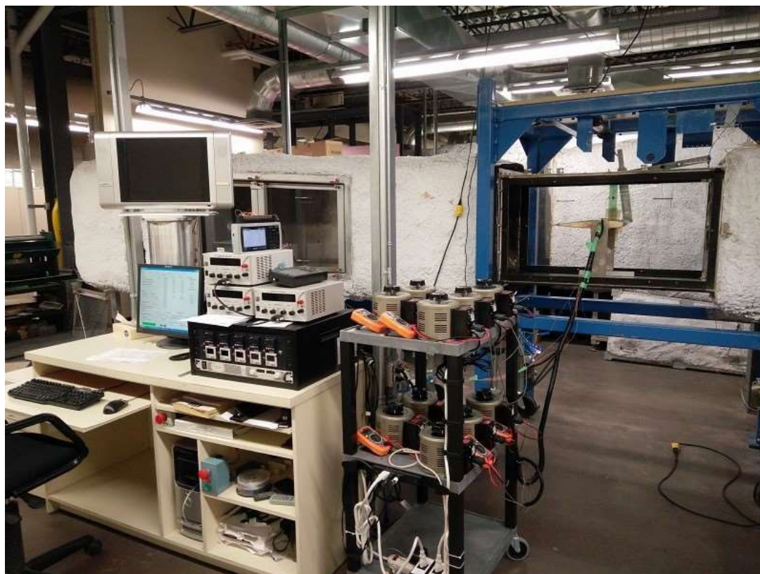
Figure 21: Montage expérimental installé dans la soufflerie réfrigérée.
