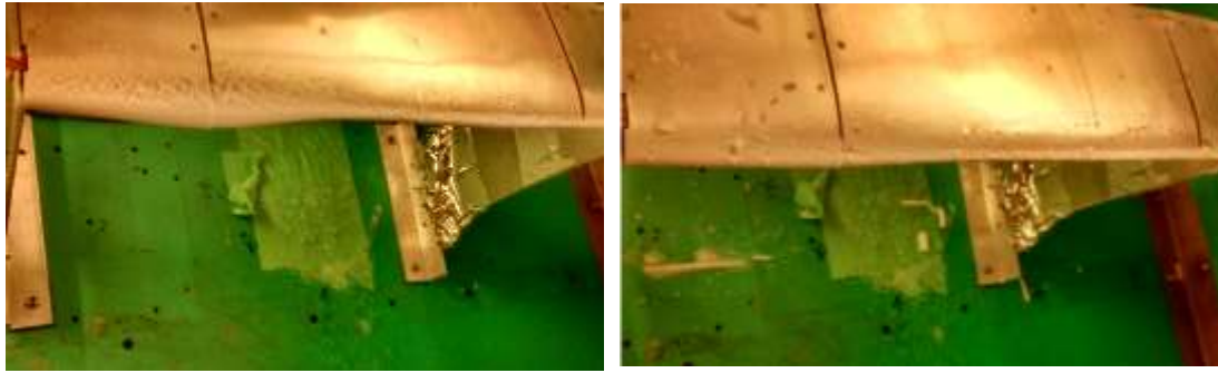
Figure 16: Vérification des réglages manuels des rotamètres afin d'obtenir une teneur en eau liquide constante le long du profil (cas étudié : 10 m/s).
