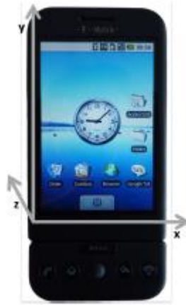
Figure 3 1 : Positionnement des axes de l'accéléromètre (Derawi et al., 2010)
