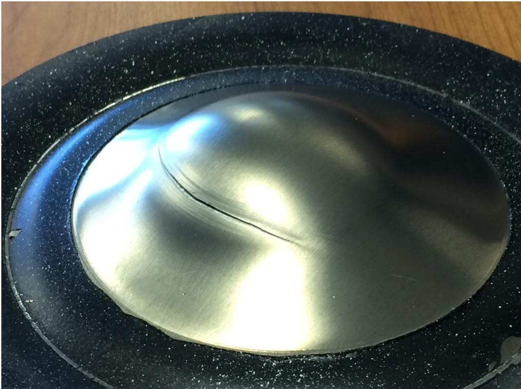
**Figure 60 : Rupture des échantillons lors de l'essai Nakazima**
