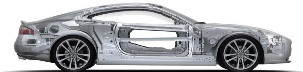
**Figure 1 : Châssis en aluminium de la Jaguar XK** (European Aluminium Association, 2013)
