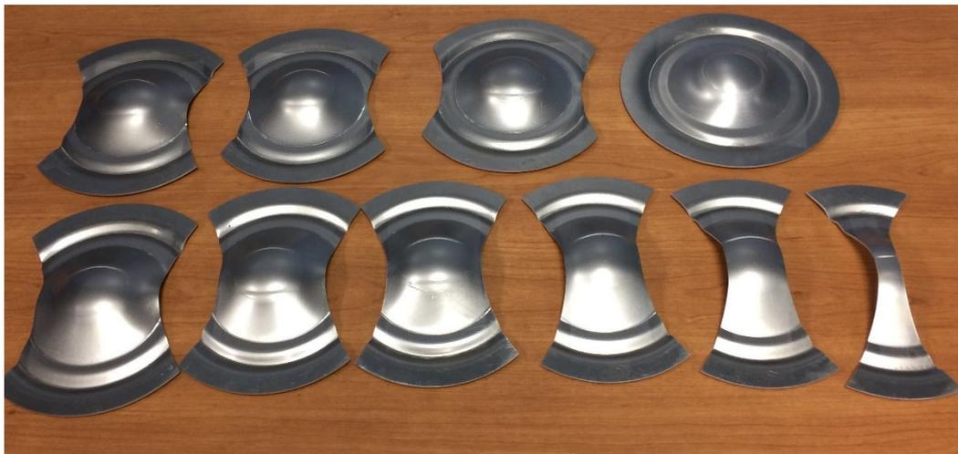
**Figure 12 : Échantillons typiques pour différents chemins de déformation**
