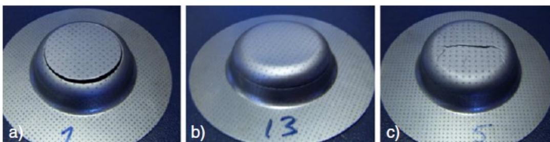
**Figure 14 : Type de rupture rencontré pendant l'essai de Marciniak (C.C. Tasan et al., 2012)**
