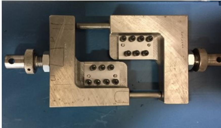
**Figure 11 : Exemple d'outillage pour l'essai de cisaillement**
