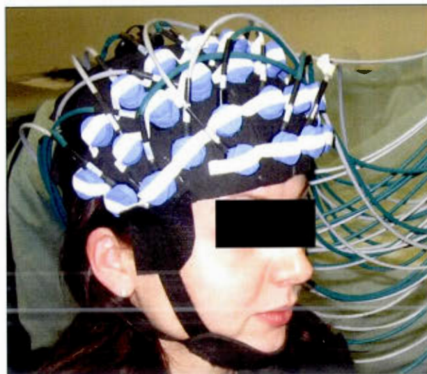
Figure 5.1 Disposition des optodes sur le casque. Sur l'image, une optode est placée sous chaque emplacement où est situé un cercle bleu ou un petit ensemble de deux à trois cercles bleus.
