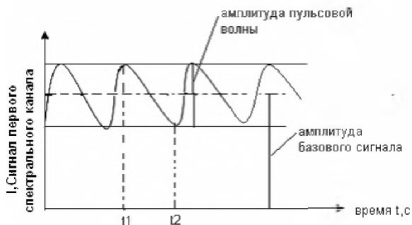
Рис. 4. Форма светового потока на фотоприемнике (пояснения в тексте) [1]
