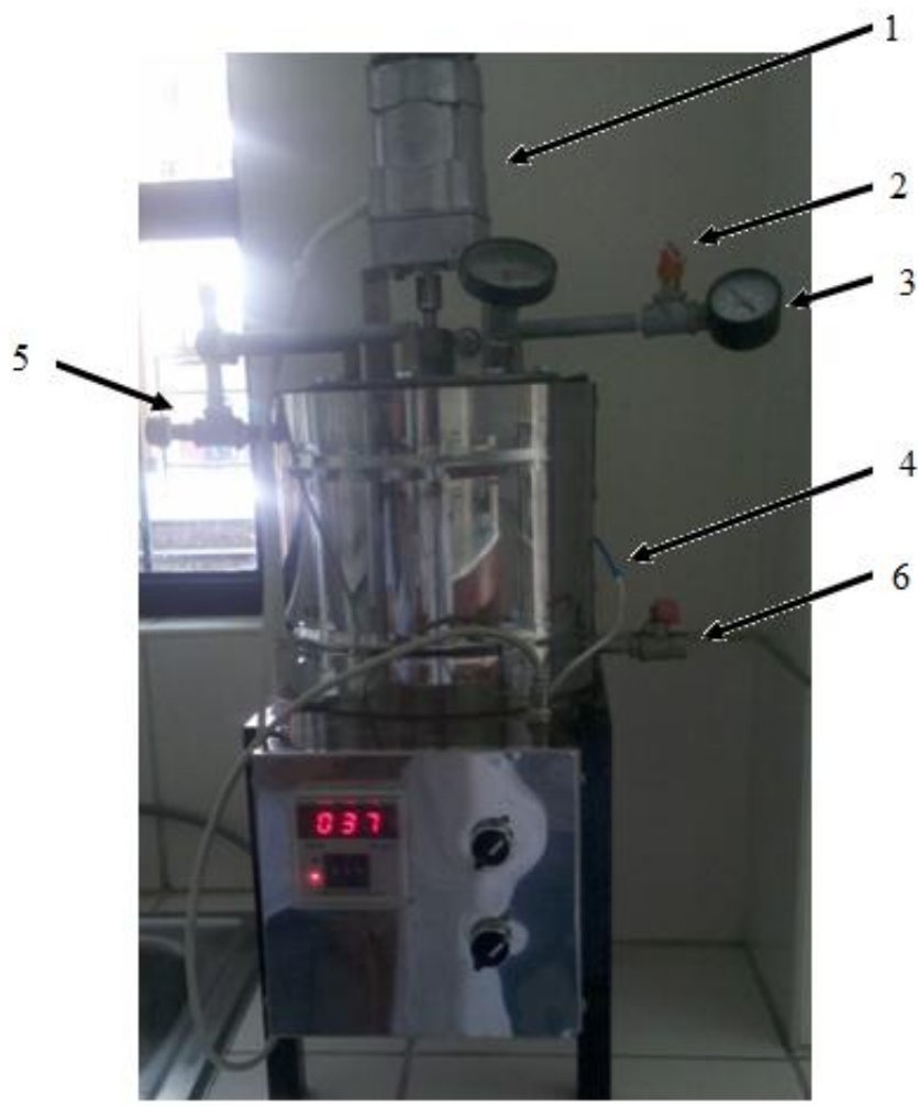
Figura N°30. Fotografía de reactor Batch utilizado en la producción de Bioetanol 1.5G, constituido por (1) Agitación, (2) Válvula de alivio de presión, (3) Manómetro, (4) Control de temperatura, (5) Entrada de agua, (6) Salida de agua.
