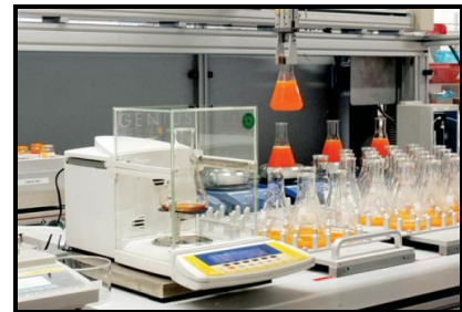
Abbildung 2-24 Kartesischer Roboter in vollautomatischer Anlage BASF
