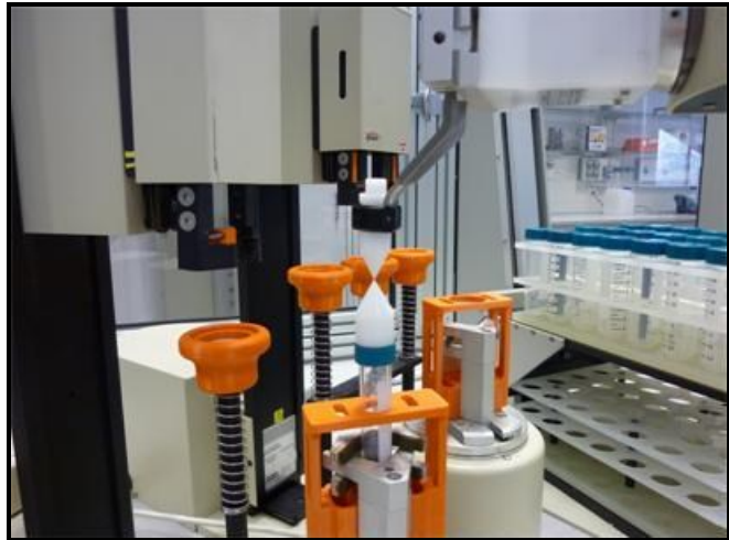
Abbildung 4-2 Teach-Vorgang für den Capper
