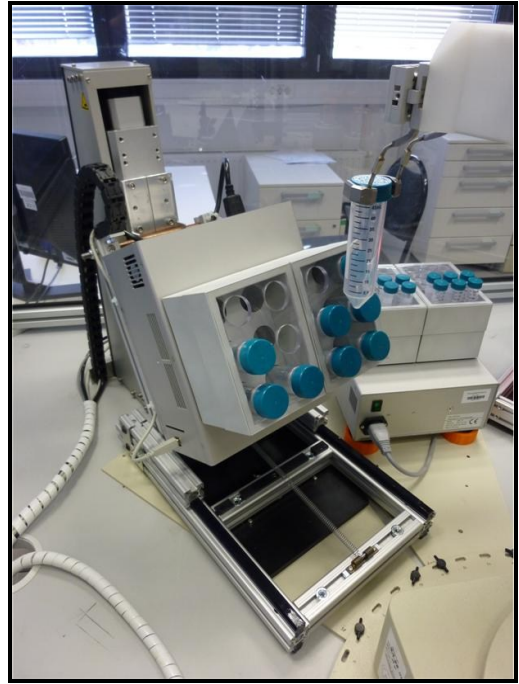
Abbildung 4-12 MKR23 in Schräglage vor der Beschickung durch den XP-Robot
