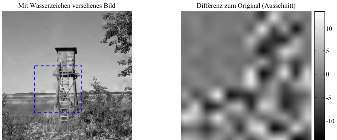
Abbildung 4.14 Beispiel eines im Verhältnis \Delta_2/\Delta_1 = 9 durch die adaptive Wasserzeicheneinbettung veränderten Bildes mit \Delta_1 = 3 (links); vergrößerter, kontrastverstärkter Ausschnitt der Differenz zum Originalbild (rechts)
