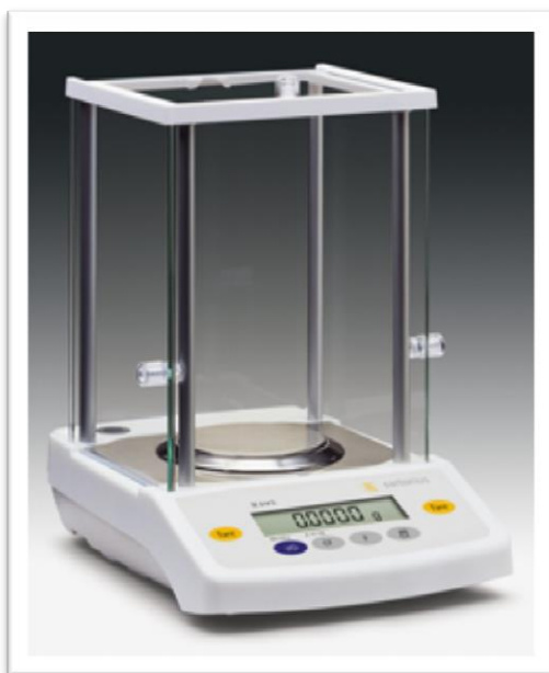
Slika 7. Analitička vaga Sartorius CPA225D – OEC [45]
