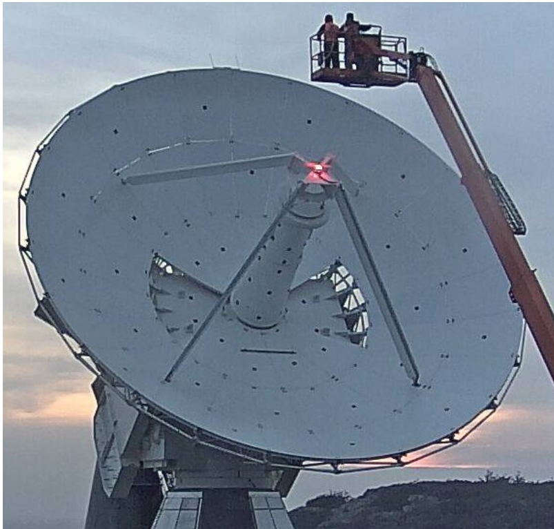
Abb. 1: OTT-Hauptreflektor mit codierten photogrammetrischen Messmarken (schwarz), die sich sowohl auf dem Hauptreflektor als auch auf dem Tubus befinden.
