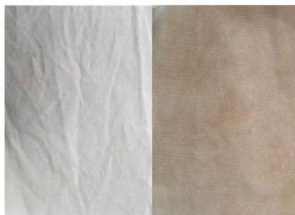
Slika 59. Fotografije kontrolne CO tkanine (levo) i CO tkanine modifikovane nanotubama \text{TiO}_2/\text{Ag} (desno)
