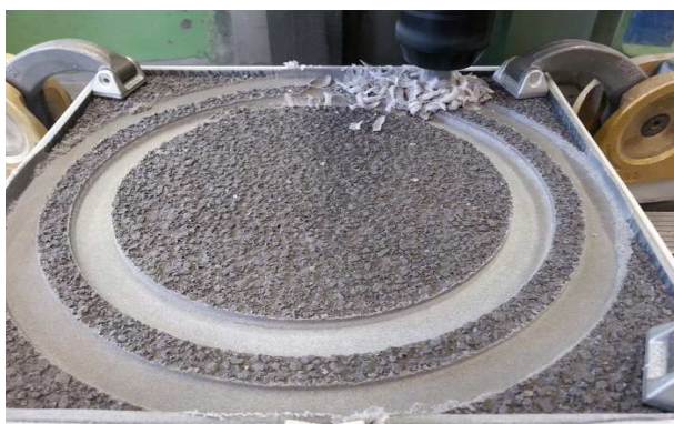
(a) Fräsvorgang zur Herstellung der Kreistaschen
