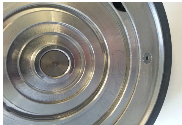
(b) Dichtlippen-Stabilisierung (verschraubt)
