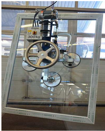
(a) Vakuum-Greifsystem für die Handhabung von Fensterelementen und Glasscheiben [2]
