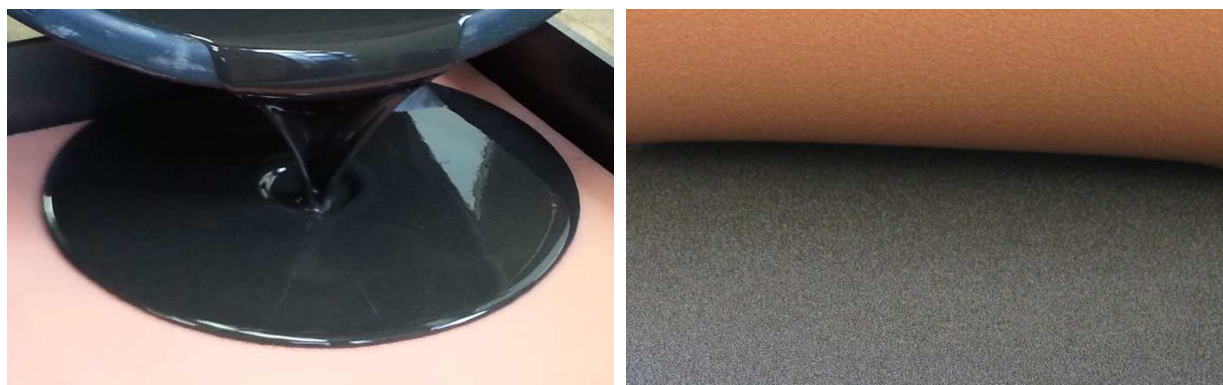
(a) Übergießen des Negativabdruckes mit einem mit Korund gefüllten Zweikomponenten-Harz (b) Ablösen des Negativabdruckes vom Replikat
