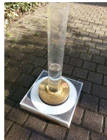
(b) Messung der Makrorauheit mit dem Ausflussmesser nach Moore
