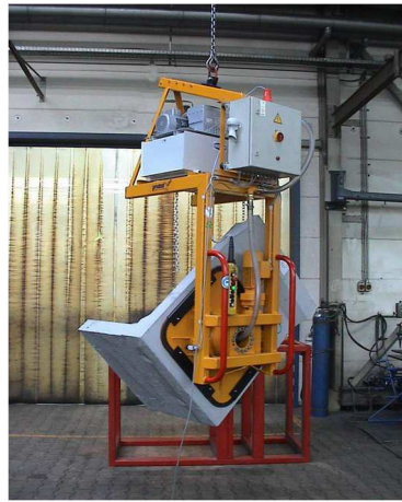
(b) Vakuum-Greifsystem für die Handhabung von Betonfertigteilen [83]
