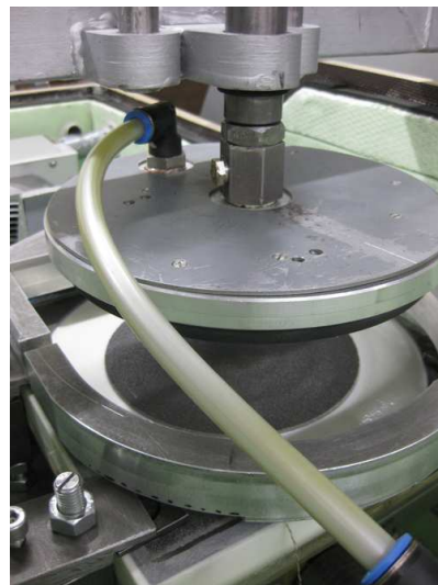
(b) Vakuumbreifer, Abspannelement und Probenschlitten
