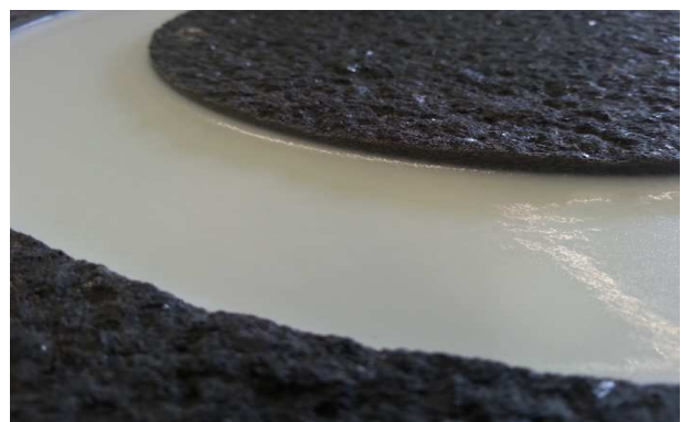
(b) Ausgefüllte Kreistasche nach Erhärtung des Zweikomponentenharzes
