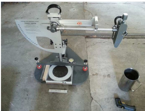
(a) Messung der Mikrorauheit mit dem SRT-Pendel
