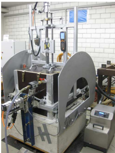
(a) Geschlossener Versuchsaufbau für Reibversuche
