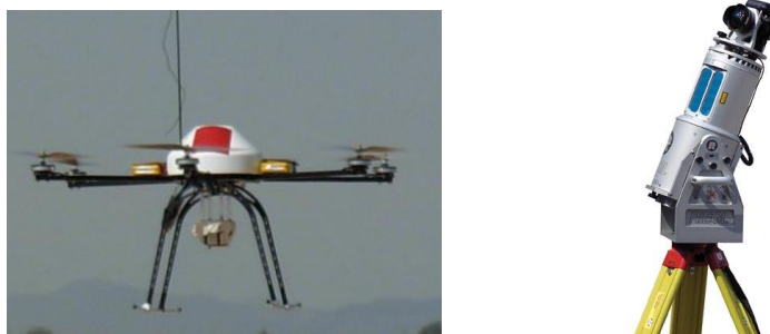
Figura 2 - Hexakopter di Mikrokopter (2012) con supporto per fotocamera (a sinistra) e laserscanner Riegl 420i (a destra)
