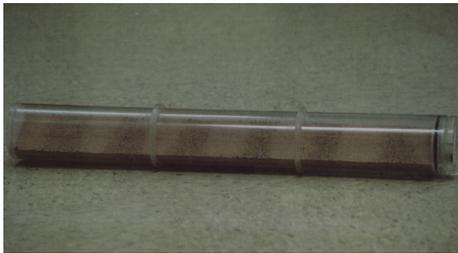
図 2.19 回転円筒中の混合粉体の相分離 [71].
