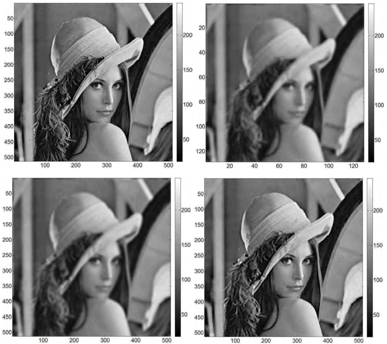
FIGURE 4.6 – Restauration de l'image complète de Lena. De gauche à droite et de haut en bas : images originale et observée, résultats par interpolation bicubique et par l'approche ADMM proposée.
