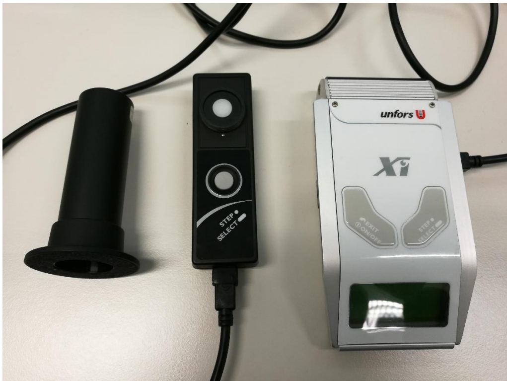
Kuva 6. Mittauksissa käytetty Unfors Xi -mallinen luminanssimittari. Vasemmalla optinen putki, keskellä valoanturi ja oikealla mittarin perusyksikkö
