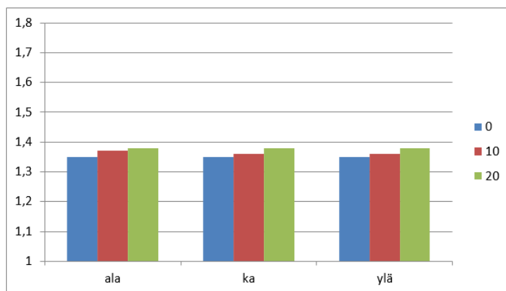
Kuva 5.16. Mitoitusmenetelmän DA1-1 mukaiset tukivoimat juuripultille laskentaesimerkissä 2. Varmuus mitoitus- ja käyttörajatilan tukivoiman suhteena.
