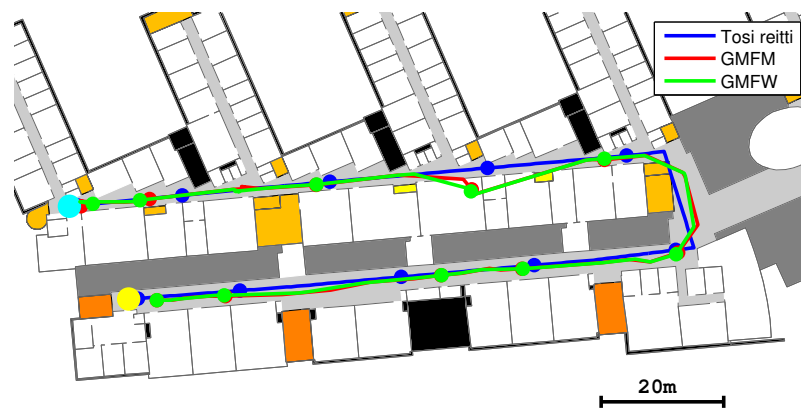
Kuva 5.5: GMFM ja GMFW suodattimien avulla estimoitu testireitti 1.
