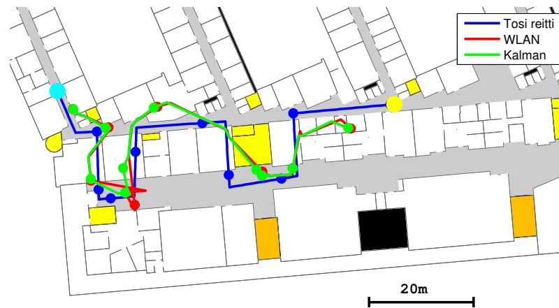
Kuva 5.6: WLAN-paikannuksen ja Kalmanin suodattimen avulla estimoitu testireitti 2.
