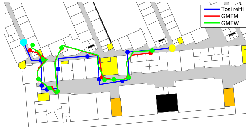
Kuva 5.8: GMFM ja GMFW suodattimien avulla estimoitu testireitti 2.
