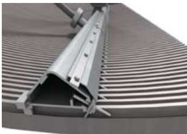
Kuva 24. Uritetun jenkkisylinterin tyypillinen imupillistö. /17/
