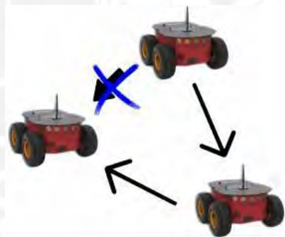
Figura 1.2: Restricción No-Holonómica de un Robot Móvil
