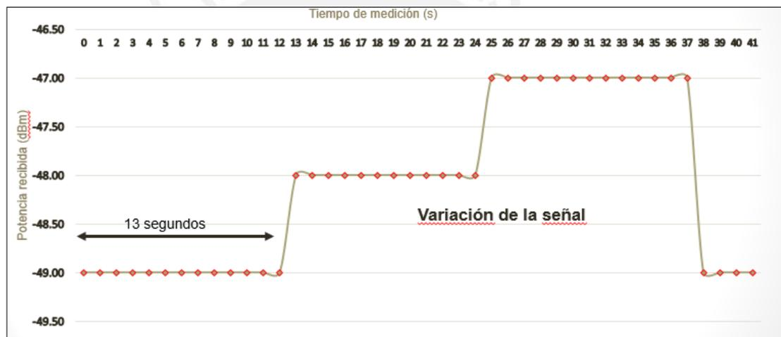
**FIGURA 5-2: COMPORTAMIENTO DE POTENCIA DE SEÑAL RECIBIDA DURANTE 42 SEGUNDOS**
