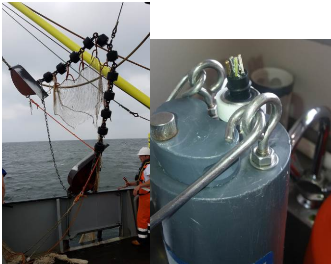
Foto 5: Links de gebroken boomkor en rechts de beschadigde CTD.
