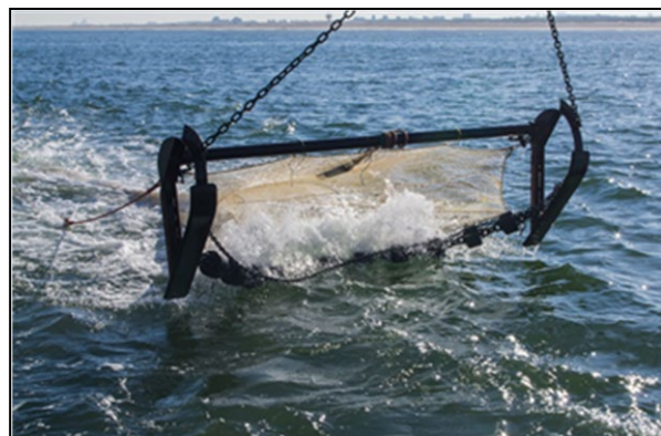
Foto 2: 3m boomkor met wekkerketting en in het net de CTD uitgezet vanaf de Luctor.
