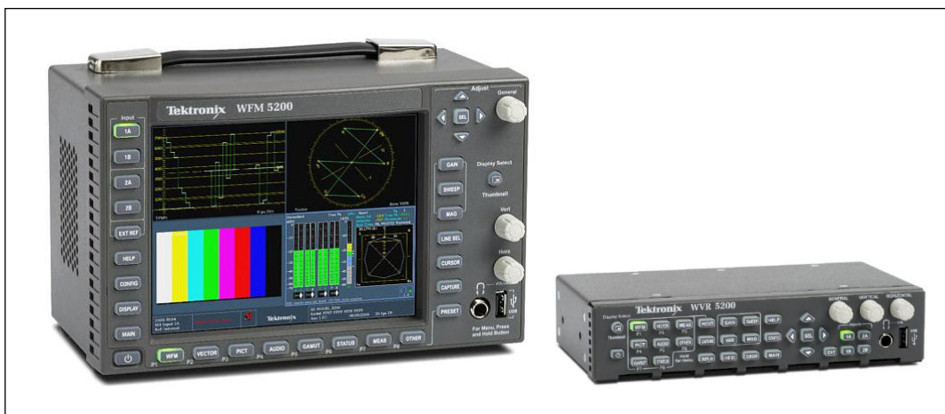
Abbildung 29: WFM und WVR 5200 für die Schnittplätze sowie Messtechnik, AZK und Abnahme [TEKTRONIX, 2012e]
