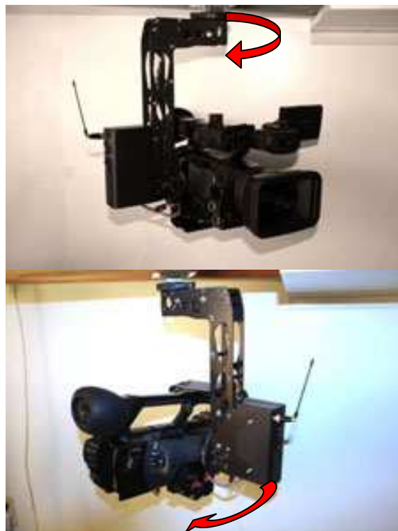
Kamerahalterung an einem Modellzeppelin mit einer Sony Z1
