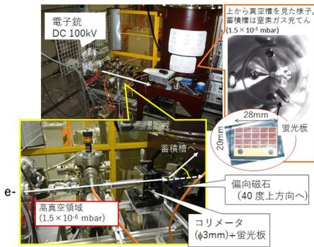
ミュオンの代わりに電子銃からの100keV 程度の電子ビームを、中心磁場100 Gaussのソレノイド磁石へ入射し、軌道直径22cmの3次元螺旋軌道を制御する実証実験を進めている。蓄積リングはJ-PARC g-2/EDM 実験のオリジナルサイズから1/3スケールダウンしている。下図の写真は、DC電子ビームが蓄積槽内で4周ほど螺旋軌道した画像である。
