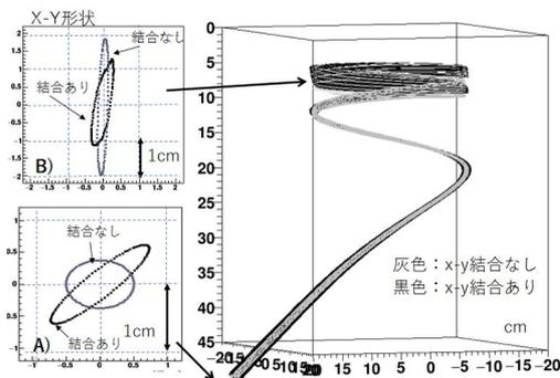
A)の入射点で、x-y結合のないビームと、x-y結合を与えたビームを入射する。B)の地点で、x-y結合がないビームはy方向サイズが4倍大きくなるが、適切なx-y結合を与えた場合はy方向サイズの変化は小さい。適切なX-Y結合を与えるために、回転4極磁石をビームラインに配置し、最適解を得るための実験を引き続き行っている。
