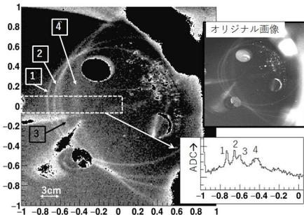
軌跡を可視化するため、蓄積槽に封入した窒素が電子軌道に沿って電離発光する様子を、真空槽上部に設置した高感度カメラで撮影した。オリジナル画像の各ピクセルの輝度情報を加工し、4周回分の軌跡を明瞭にしており、図中に番号1~4で示す。右下の1次元ヒストグラムは、画像の白い点線で囲った部分の輝度情報であり1~4周目に対応するピーク形状が見られる。また、4周目は1周目に比べて軌跡が広がっている様子も定性的に分かる。蓄積槽内部の蛍光板に映る像からも、ビーム断面が広がる様子を確認している。これは、ビームのx-y結合がマッチしていないために起こる問題で、この問題の定量的な解決手法の決定が本研究の第一目的であった。下図に2通りのx-y断面形状のビームの入射計算例を示す。
