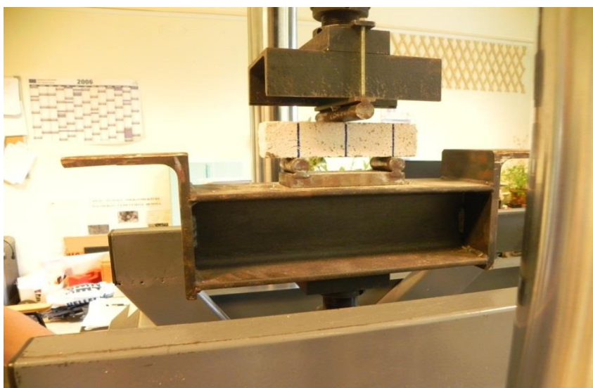
Slika 6: Prikaz upogibne preiskave apnene prizme.
